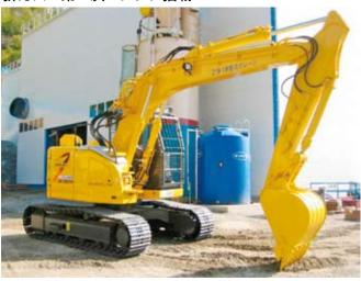
トンネル専用キャビンやエンジン、マフラーを搭載し、細部まで整備を施しているので安心してお使い頂けます。
